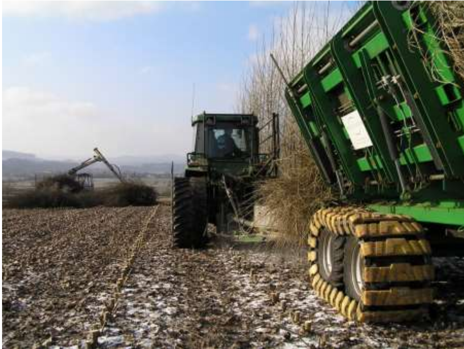
Abbildung 25: Ganzbaumernte mit dem „Stemster“ am Standort Allendorf (Wangert 2012).
